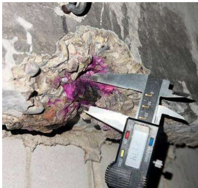
9 pav. Nustatytas denginio plokštės armavimas
