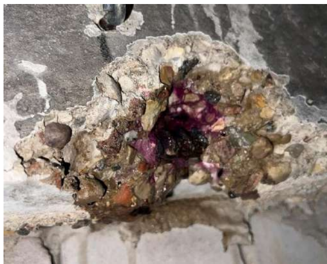
8 pav. Nustatytas denginio plokštės betono šarmingumas
